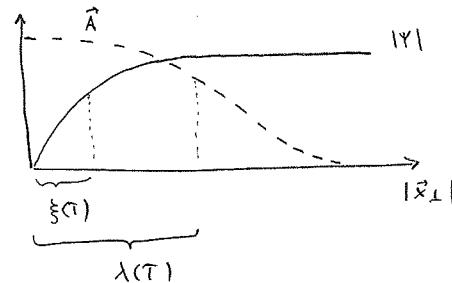
Das magnetische Feld ist ungleich null für kleine  $|\vec{x}_\perp|$ , und ein Fluss kann existieren:
