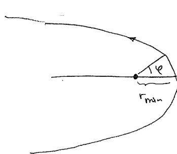
$$r = \frac{p}{1 + \varepsilon \cos \varphi} \quad ; \quad r_{\min} = \frac{p}{1 + \varepsilon} \quad \text{für } \varphi = 0; \\ r \rightarrow \infty \quad \text{für } \cos \varphi \rightarrow \left(-\frac{1}{\varepsilon}\right)^+$$
